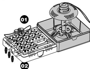
8. Установите выключатель (1) в базу с отверстиями (3). Затем установите 3 соединителя (2), узким концом вниз.
