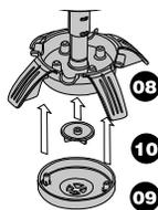
5. Установите блок спиннинга (10) снизу основания фонтана (8). Затем закрепите замок для базы фонтана (9) и защелкните ее.
