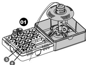
9. Подключите черный провод от батареи и черный провод от фонтана к соединителю (а). Затем подключите красный провод от фонтана к соединителю (b). красный провод включателя подключите к соединителю (b).
