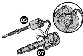
2. Вставьте собранный модуль мотора в одну из частей трубки фонтана (7). Обратите внимание на рисунок. Провода должны выходить из верхней широкой части.
