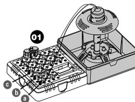
10. Подключите другой красный провод включателя к соединителю (с). Красный провод от батареи подключите к соединителю (с).
