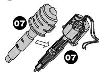
3. Соедините две части трубки фонтана (7) вместе.
