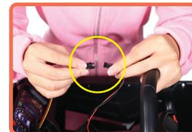
8. Подключите питание руля: соедините провод питания руля с проводкой на корпусе.
