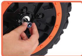
2. Используйте гайки и шайбы, снятые во время шага 1, для крепления колеса.
