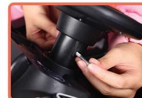
9. Возьмите винты и гайки, снятые во время шага 7, и вставьте их в отверстия для крепления руля.
