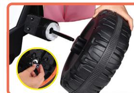
5. Установите колесо на ось и закрепите заднее колесо снятой гайкой и шайбой.
