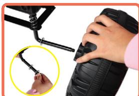
1. Установите передние колеса: открутите гайку, снимите шайбу и совместите колесо с передней осью.
