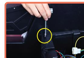
12. Снимите детали с концов винтов крепления сиденья.
