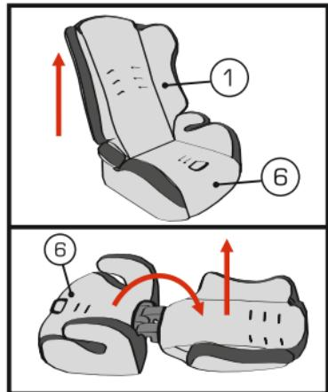
Перед снятием спинки внутренние 5-ти точечные ремни должны быть демонтированы (см. п. 2.1).
