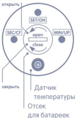
**SET/ON** — включение/выключение и установка максимальной температуры. Чтобы включить или выключить термометр, нажмите и удерживайте эту кнопку 1 секунду. Чтобы установить максимальную температуру, нажмите и удерживайте кнопку 3 секунды.
