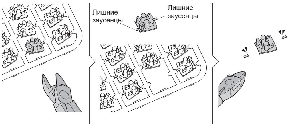
Некоторые заусенцы могут остаться на краях пластиковых деталей после того, как вы их отрезали. Убедитесь, что все заусенцы полностью удалены, чтобы избежать неисправностей при работе робота.
