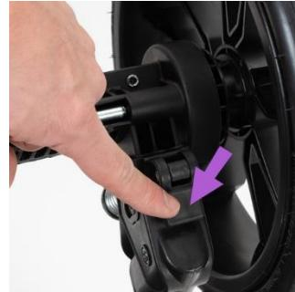
16. Для регулировки основного амортизатора поверните его нижнюю часть:
