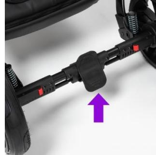
15. Жесткость пружинного амортизатора регулируется переключателем, расположенным непосредственно под задней осью:
