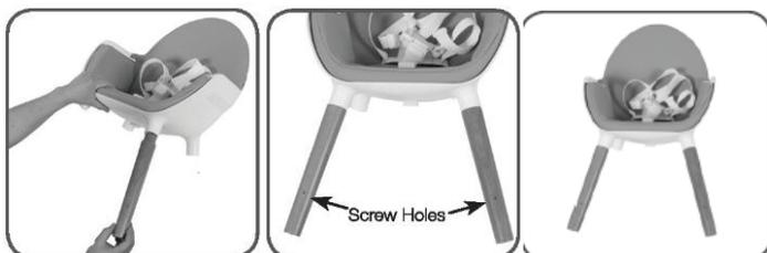
2. Убедитесь, что предварительно просверленные отверстия находятся на одинаковом уровне и зафиксируйте подножку с помощью двух винтов.
