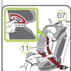
Правильно отрегулированный подголовник (07) обеспечивает оптимальное положение диагонального ремня (11) и гарантирует ребенку оптимальную защиту. Регулярно проверяйте, подходит ли высота подголовника (07) к росту ребенка. Подголовник (07) должен быть отрегулирован таким образом, чтобы между плечами ребенка и подголовником (07) могли пройти два пальца.
