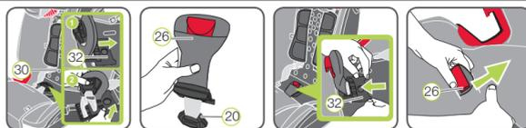
10. Переверните серую сменную пластину **32**, чтобы крепление SecureGuard **(B)** **26** находилось сверху, а замок ремня **(A)** **20** — снизу.
