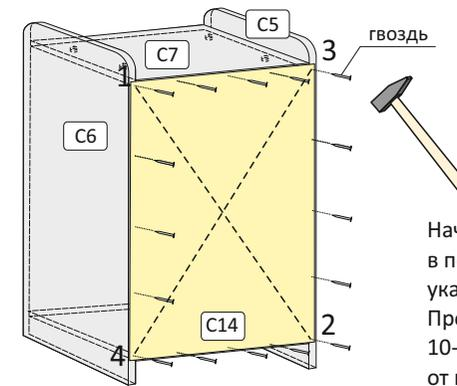
Начать забивать гвозди в последовательности, указанной на схеме. Продолжить с интервалом 10-15 см, отступая 4 мм от края ДВП.
