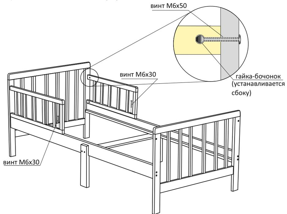
**Внимание!** Изголовья универсальные, возможна установка боковых ограждений как слева, так и справа, а так же установка на одну сторону (см. рисунок ниже)
