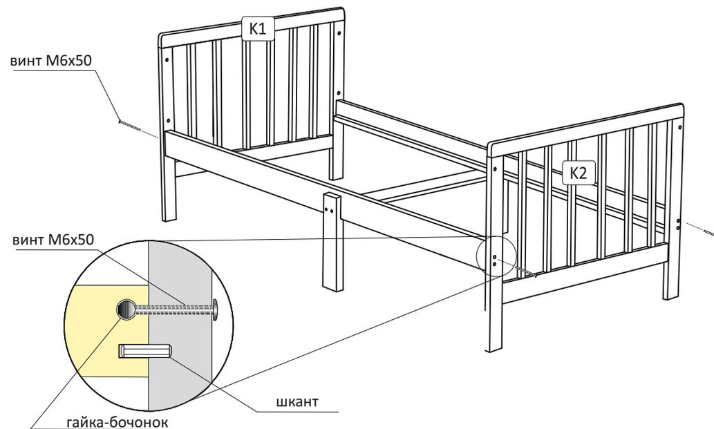
**2Г** Закрепить боковые стенки к изголовью с помощью винтов М6х50 и гаек-бочонков, а к основанию, с помощью винтов М6х30, как показано на рисунке.
