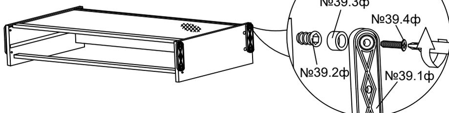
5. Установите кровать на основание и поочередно соедините винтами **№39.4ф** детали механизма качания **№39.1ф**, **№39.3ф** с резьбовыми втулками **№39.2ф** в опорах маятника. Наклоните кровать и закрепите сначала два маятника с одной стороны, затем - с другой. В резьбовые втулки **№39.2ф** вкрутите фиксаторы **№39.5ф**. Установите ящик на роликовые направляющие **№29ф**.
