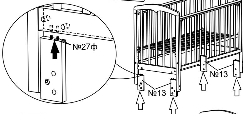
3. Закрепите опоры маятника **№13** на спинках кровати с помощью винта **№36ф** и гайки-бочонка **№35ф**.
