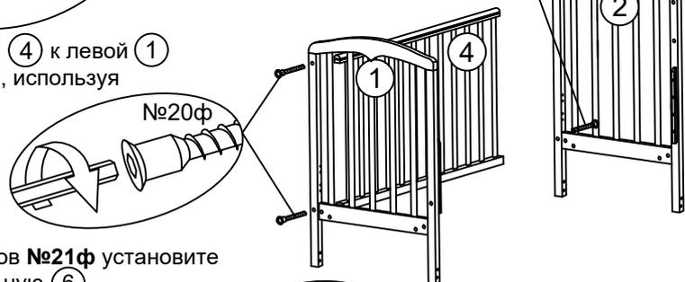
3. С помощью винтов-конфирматов №21ф установите на кровать планку дополнительную (6).
