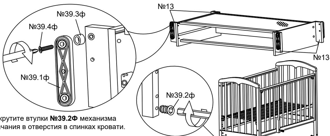
3. Вкрутите втулки №39.2Ф механизма качания в отверстия в спинках кровати.
