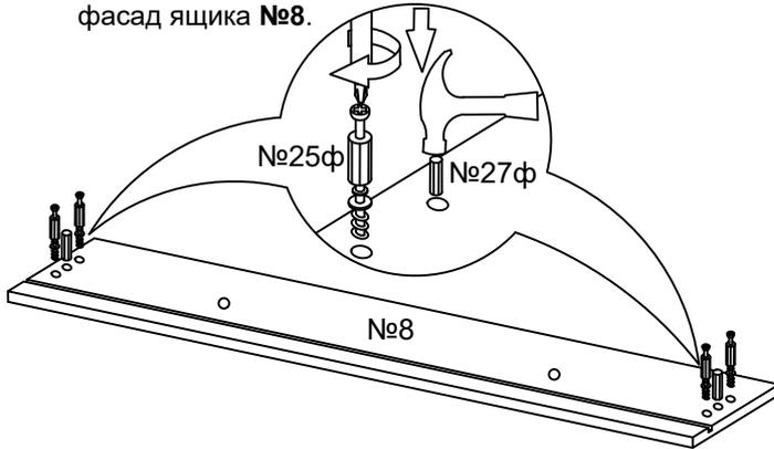
4. При помощи шкантов №27ф и эксцентриковых стяжек №26ф закрепите фасад ящика №8 на боковых стенках №9 и №10.
