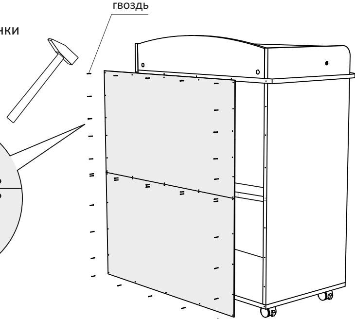
Начать забивать гвозди в последовательности, указанной на схеме.
