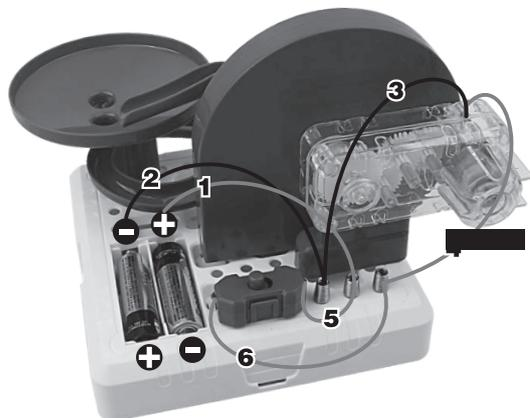
Соедините провода выключателя с пружинами:
