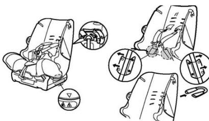
③ Используйте отвертку, чтобы снять пряжку ремней под сидением автокресла
