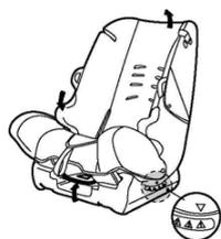
② Установите автокресло плотно к сиденью автомобиля лицом вперед по направлению движения автомобиля. Снимите подголовник сиденья автомобиля и отрегулируйте положение сиденья автомобиля, если это предусмотрено конструкцией сиденья вашего автомобиля.
