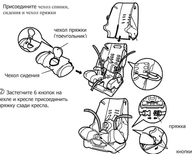
Установите накладки на плечевые Ремни, проденьте ремни через отверстия в спинке кресла и закрепите пряжкой сзади
