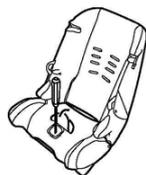
② Удалите рычаг. Винт, чтобы не потерять его, поставьте на место.
