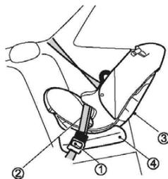
Вид автокресла, закрепленного на заднем сидении автомобиля за местом водителя.
