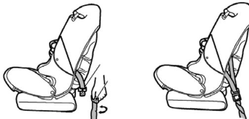
В случае если застежка автомобильного ремня находится все еще высоко даже после скручивания, попробуйте установить автокресло на другое место в автомобиле. Иначе автокресло не будет правильно функционировать.
