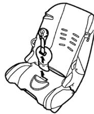
Снятие ремня- регулятора натяжения.
