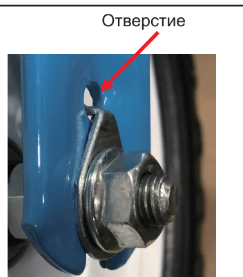
g. Вставьте колесо в переднюю вилку, затем разместите шайбу так, чтобы она попала в отверстие (см. рисунок выше).
