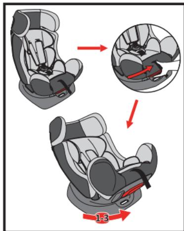
● Автокресло имеет три фиксированных положения. Изменять положение наклона автокресла допустимо только до установки его на сиденье автомобиля.
