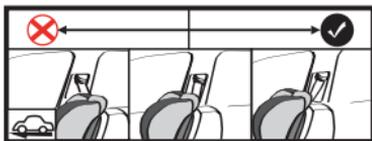
**!** При установке по направлению движения с использованием штатного 3-х точечного ремня безопасности автомобиля необходимо проконтролировать, чтобы верхняя точка крепления ремня безопасности находилась на уровне или позади детского автокресла.
