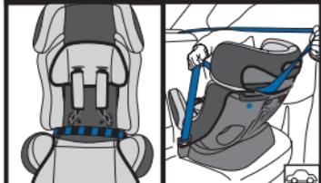
● Протяните поясную часть штатного ремня безопасности автомобиля через прорезы в корпусе автокресла. При наличии мягкого вкладыша 5 поясная часть должна проходить под ним.
