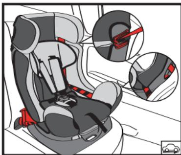
Надавите на автокресло рукой или коленом, чтобы оно плотно прилегало к спинке сиденья автомобиля. Натяните ремень безопасности и зафиксируйте его диагональную часть при помощи фиксатора штатного ремня 9.
