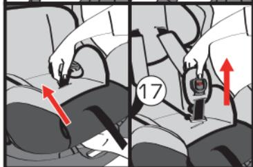
● Если есть необходимость извлечь мягкий вкладыш спинки (при его наличии) протолкните скобу 17 центральной ляжки 12 узкой стороной в прорезь автокресла снизу и выньте из автокресла и вкладыша спинки, после чего снова установите центральную ляжку, выполнив действия в обратном порядке.
