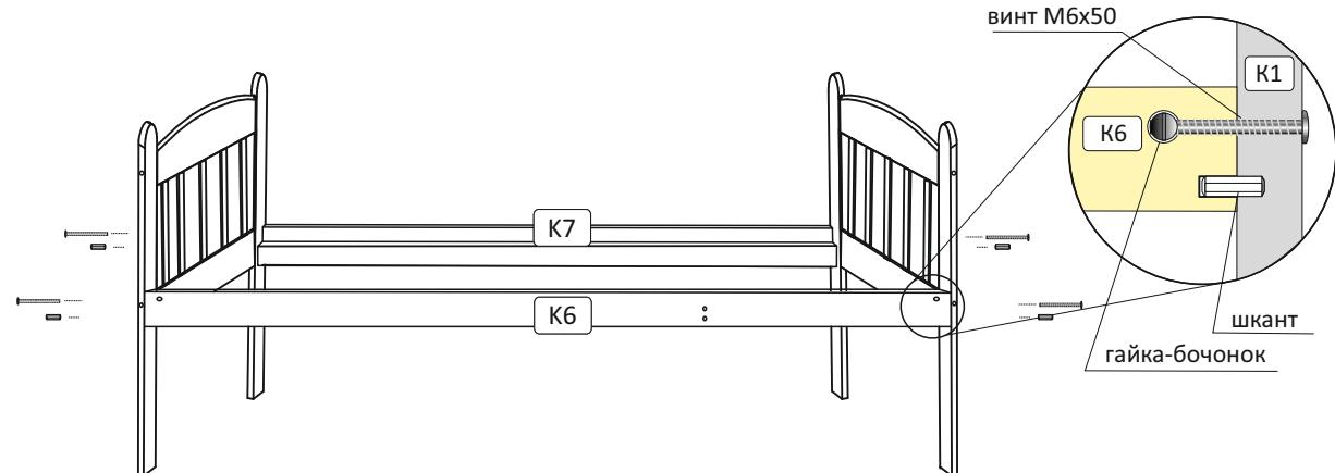
**2Б** Установить задний бортик (K10) и передний бортик (K9) с помощью винтов M6x50 и бочонков.
