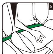
Поместите диагональную секцию ремня безопасности и секцию поясного ремня на стороне пряжки автомобильного ремня безопасности в нижнюю направляющую ремня (рис. 56).
