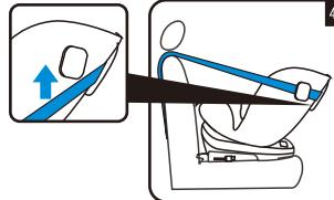
Направьте якорный ремень вдоль одной стороны и вставьте верхнюю направляющую ремня, затем прикрепите крюк якорного ремня к точке крепления (см. раздел 4.7) (рис. 43).
