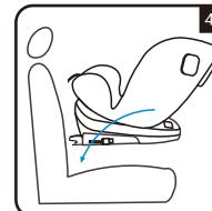
Поверните кресло в положение лицом назад (см. раздел 4.5), отрегулируйте кресло и зафиксируйте его в максимально наклонном положении (см. раздел 4.4). Расположите кресло в направлении, противоположном ходу движения (рис. 39, 40, 41).
