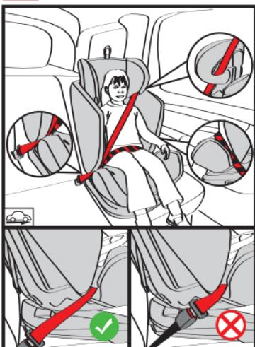
Усадите ребенка в автокресло и пристегните его 3-х точечным ремнем безопасности автомобиля так, чтобы верх диагональной части ремня безопасности проходил через направляющую ремня безопасности подголовника, а низ диагональной части и поясная часть – через прорезь между спинкой и сиденьем автокресла.
