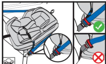
Надавите на автокресло, чтобы оно плотно прилегало к спинке сиденья автомобиля. Натяните ремень безопасности по всей длине и зафиксируйте его диагональную часть с помощью фиксатора штатного ремня максимально близко к пряжке ремня безопасности автомобиля.
