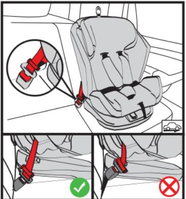
Надавите на автокресло, чтобы оно плотно прилегало к спинке сиденья автомобиля. Натяните ремень безопасности по всей длине и зафиксируйте его диагональную часть с помощью фиксатора штатного ремня максимально близко к пряжке ремня безопасности автомобиля.
