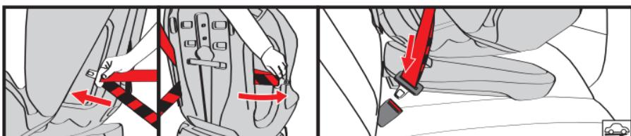
Протолкните пряжку ремня безопасности автомобиля в ближайшую прорезь для ремня безопасности, а затем протяните его по спинке, выньте через другую прорезь и пристегните его.
