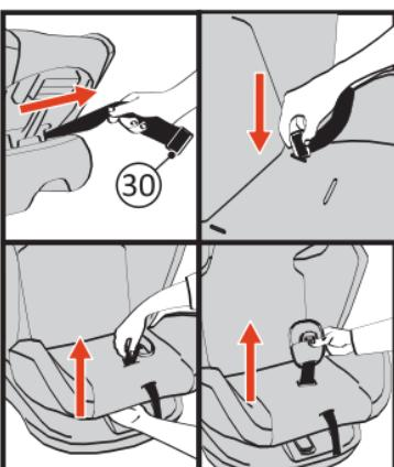
Для полного демонтажа внутренних ремней автокресла оно должно находиться в положении против хода движения (п. 1.2) и наклонено в положение «лежа» (см. п.1.1):
