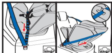
Протяните поясную часть ремня безопасности автомобиля по синим меткам между спинкой и сиденьем автокресла и пристегните ремень. Диагональную часть ремня безопасности автомобиля направьте по спинке и далее по направляющей ремня безопасности спинки.
