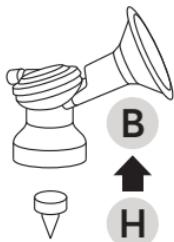
Установите клапан снизу в корпус.
