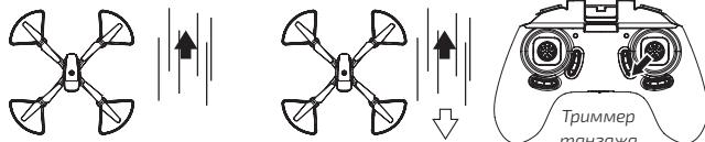
Если дрон при нейтральном положении ручек постоянно дрейфует назад, нажимайте верхнюю часть триммера танглажа.
