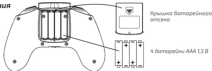
Откройте крышку батарейного отсека, строго соблюдая полярность («+» и «-»), как показано на рисунке, вставьте в отсек 4 батарейки «AAA» 1.5В (батарейки в комплект не входят), а затем закройте крышку батарейного отсека пульта управления.
