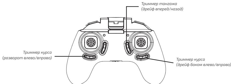
Если дрон при нейтральном положении ручек постоянно дрейфует вперед, нажимайте нижнюю часть триммера танглажа.
