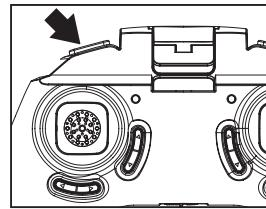
6. После того, как дрон установит связь с пультом управления, нажмите эту кнопку, чтобы разблокировать моторы. Чтобы остановить моторы, нажмите на эту кнопку еще раз.
