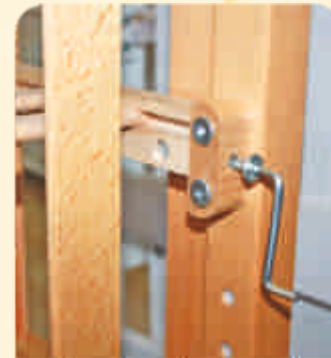
11. Соединить жесткое основание с держателем жесткого основания при помощи винта М6х55 и бочонка
