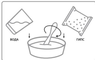
**ШАГ 2.** Смешиваем раствор. Для этого в уже приготовленную емкость наливаем воды и постепенно высыпая гипс, постоянно помешивая ложкой или палочкой. Разводим гипс до состояния жидкой сметаны в соотношении 3/2: 3 части гипса и 2 части воды. Обратите внимание, что гипс быстро застывает в течение 10 минут, поэтому заливать раствор в формочки нужно быстро.
