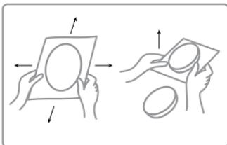
**ШАГ 4.** Достаем отливку из формы. Примерно через 40 минут можно будет доставать отливку. Для этого нужно слегка растянуть форму за края, а потом, перевернув, снять форму с отливки. Если фигурка не выходит, то слегка похлопайте формой о ладошку. Отливка должна получиться гладкой и прочной.
