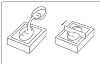
**ШАГ 3.** Заливаем форму. Аккуратно заливаем раствор в пластиковую форму. Чтобы в форме не оставалось пустот и раствор равномерно заполнил всю емкость, форму нужно немного потрясти. Удалите излишки раствора, сделав поверхность отливки максимально ровной.
