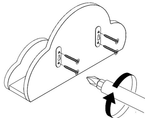
2. В отверстия на стенке большой установить навесы, закрепив при помощи саморезов 3,5x16.
