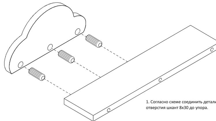
1. Согласно схеме соединить детали, установив в отверстия шкант 8x30 до упора.
