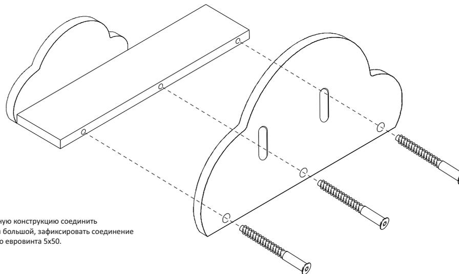
2. Собранный конструкцию соединить со стенкой большой, зафиксировать соединение с помощью евровинта 5x50.
