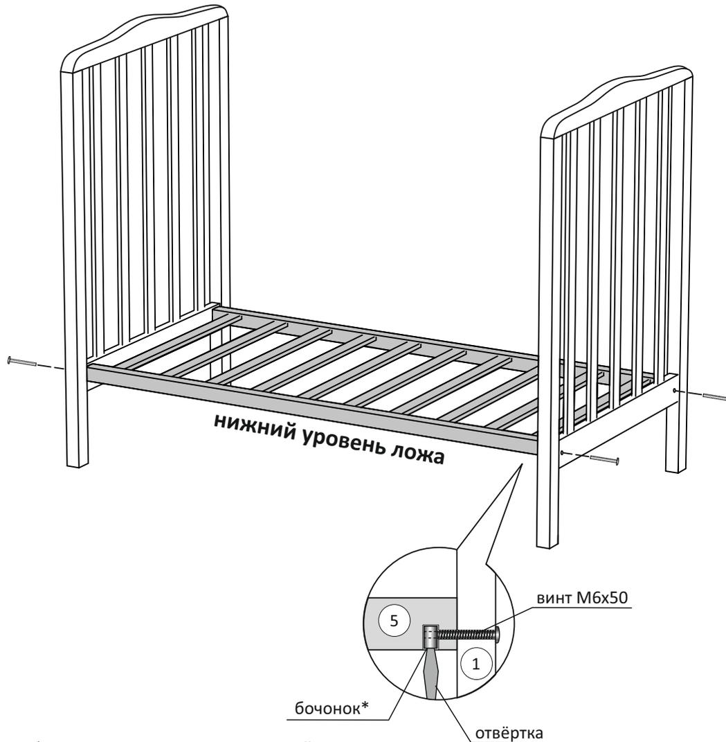
\* Бочонок устанавливается шлицей вниз. Чтобы бочонок и винт были соосны во время установки можно зафиксировать шлицу перпендикулярно спинке плоской отвёрткой.
