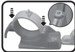
2. Вставить маленькую опорную деталь трека в паз в задней части башни так, как показано. Затем соединить вместе два длинных прямых трека. Вставить крюкообразный торец в левую сторону механизма пуска и вставить противоположный торец длинного трека в паз в основании трека-петли до «щелчка», свидетельствующего о том, что трек встал на положенное место. Полностью собранный длинный трек должен быть прикреплен к насечке в опорной детали малого трека.
