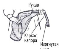
1. Вставьте каркас через отверстия в капоре.
