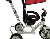
9. Вставьте родительскую ручку в отверстия в нижней части колонки рулевого управления до щелчка.
