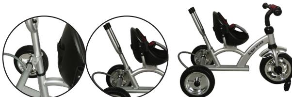
5. Вставьте нижние детали рулевого управления в раму.
