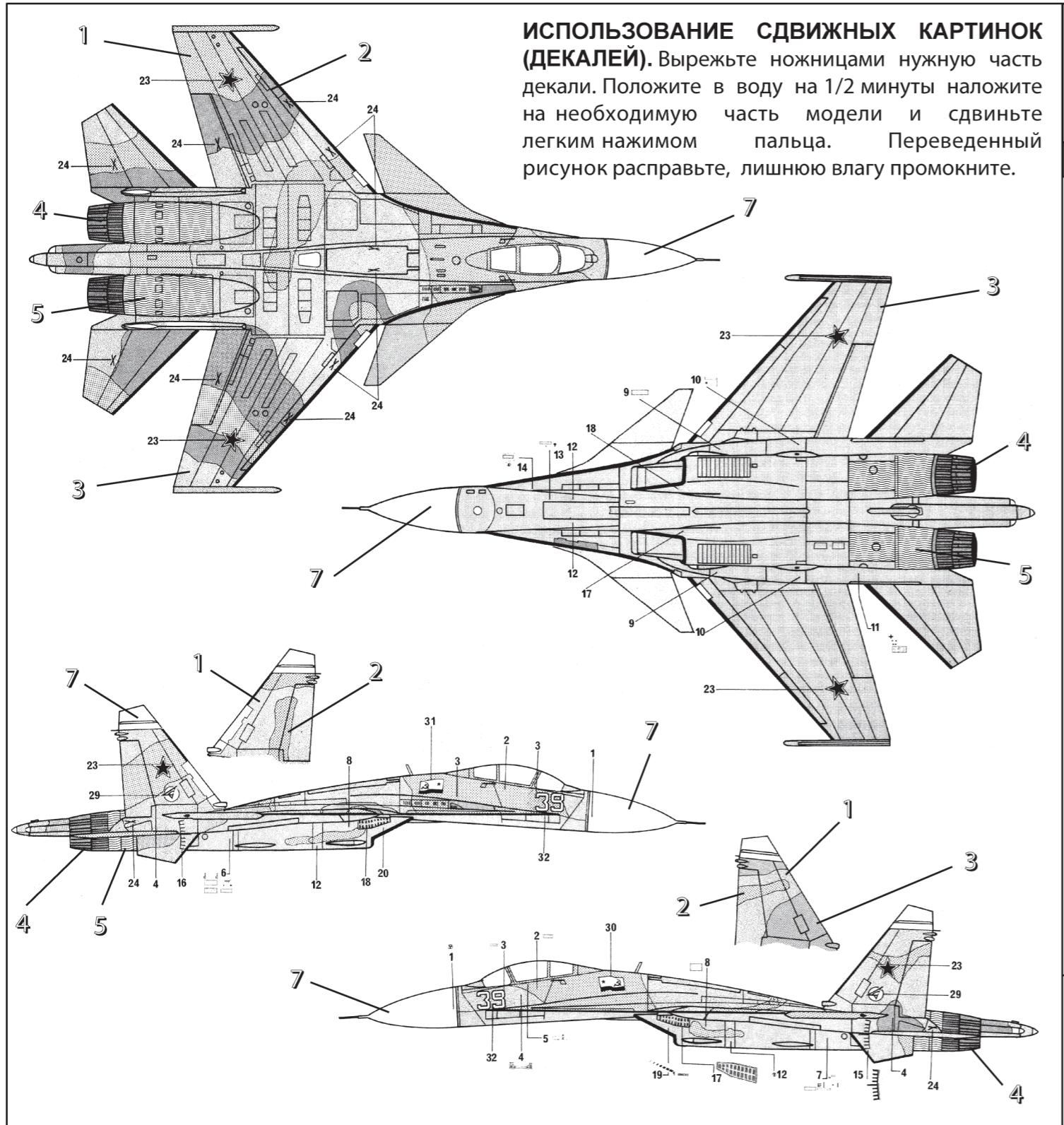
**ИСПОЛЬЗОВАНИЕ СДВИЖНЫХ КАРТИНОК (ДЕКАЛЕЙ).** Вырежьте ножницами нужную часть декали. Положите в воду на 1/2 минуты наложите на необходимую часть модели и сдвиньте легким нажимом пальца. Переведенный рисунок расправьте, лишнюю влагу промокните.
