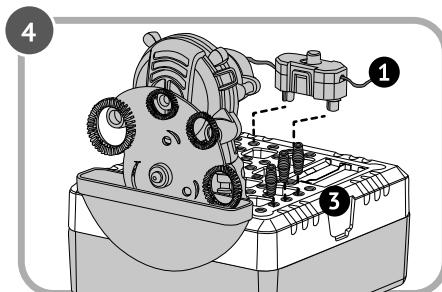
4. Установите выключатель (1) на базе с отверстиями (3). Затем установите 3 соединителя (2), узким концом вниз.
