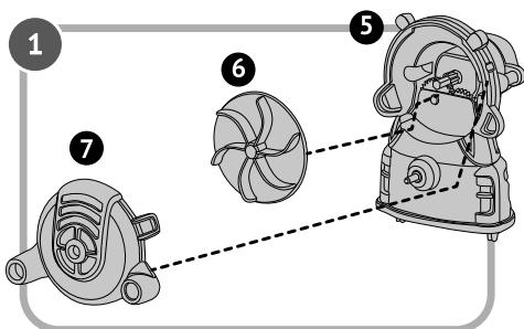
1. Соедините крутящийся блок (6) с вентилятором (5). Вставьте его, как показано на рисунке. Прикрепите крышку вентилятора (7) к вентилятору (5).
