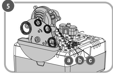
5. Подключите 2 черных провода к соединителю (а). Затем подключите красный провод от вентилятора (5) к соединителю (б). Подключите красный провод от выключателя к соединителю (в).
