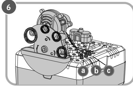
6. Подключите другой красный провод выключателя к соединителю (с). Нажмите кнопку на выключателе, и мыльные пузыри полетят!
