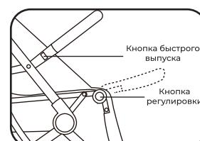
**Регулировка угла наклона подставки для ног:** Как показано на рисунке, нажмите и удерживайте левую и правую кнопки подставки для ног обеими руками, чтобы отрегулировать угол наклона подставки для ног.
