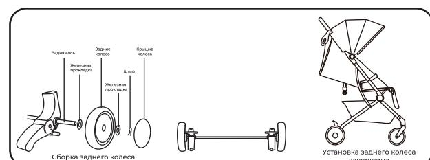
Как показано на рисунке, наденьте железную шайбу, заднее колесо и железную шайку на заднюю ось, зафиксируйте конец вала штифтом, а затем закройте колпак колеса, чтобы завершить установку узла заднего колеса. Установите заднее колесо на заднюю ножную трубу.
