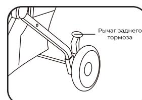
**Тормоза задних колес:** Как показано на рисунке, нажмите на рычаг тормоза заднего колеса, чтобы заблокировать заднее колесо; поднимите рычаг тормоза, чтобы разблокировать его.
