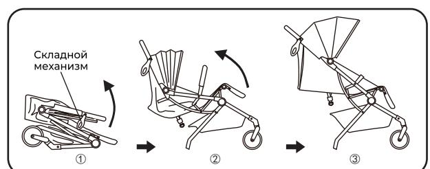
Как показано на рисунке, откройте складной механизм, поднимите ручку, чтобы растянуть корпус, пока не услышите звук "щелчок", а затем осторожно нажмите на ручку, чтобы убедиться, что корпус полностью развернут и надежно зафиксирован.
