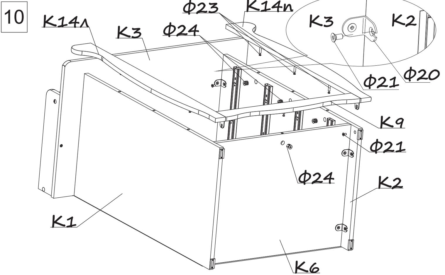
Перед установкой задней стенки следует при помощи рулетки или шнура проверить диагонали полученного каркаса.
