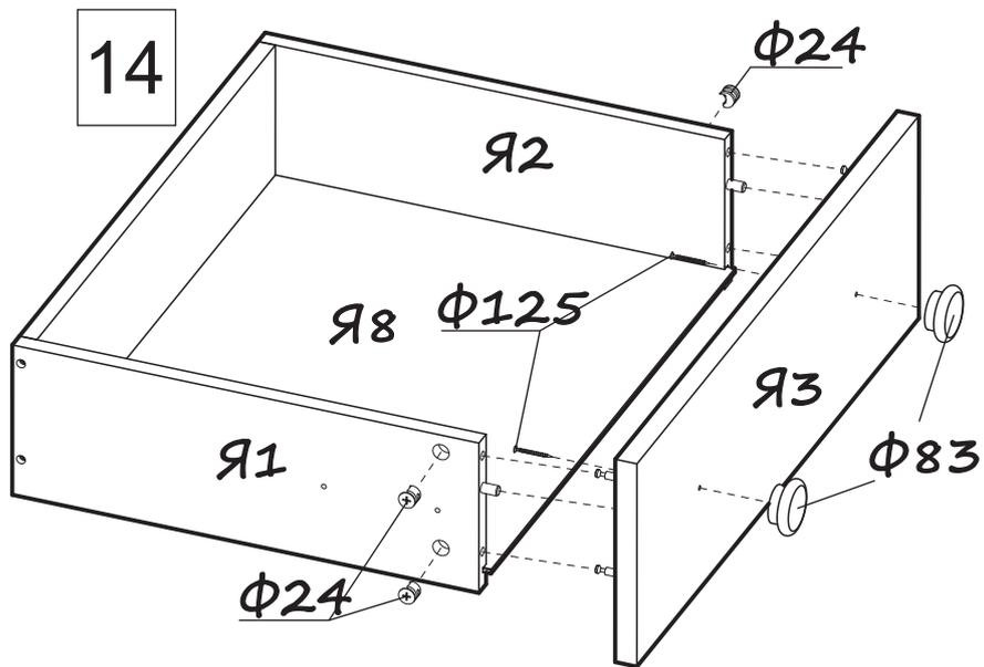
Перед установкой стабилизаторов следует при помощи шнура или рулетки проверить диагонали ящика. Диагонали должны совпадать ( $L1=L2$ ).
