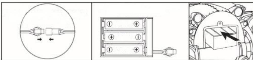
5. Закройте крышку батарейного отсека и не забудьте вкрутить фиксирующий винт.
