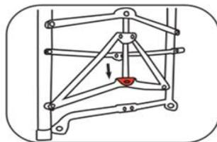
2. Нажмите на пластиковую ступеньку под задней частью платформы до щелчка - коляска надежно зафиксирована.
