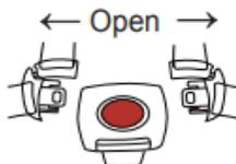
10. Для использования пятиточечного ремня безопасности, вставьте ремни в соответствующие отверстия на замке до щелчка.
