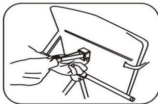
4. Для регулировки угла наклона спинки удерживайте кнопку d - типа на обратной ее стороне (на задней части коляски).
