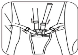
12. Перед использованием коляски убедитесь, что все предохранительные устройства заблокированы, колеса надежно установлены и педали тормоза нажаты на обоих задних колесах. Отрегулируйте длину ремней безопасности, как показано на рисунке.
