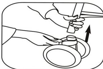
5. Установите передние и задние колеса на оси, надавите до щелчка. Проверьте, надежно ли закреплены колеса, потянув их в противоположную сторону. Если колесо потребуется снять – нажмите на выступающий фиксатор, одновременно тяните колесо вниз.
