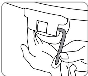
7. Зафиксируйте сиденье на раме в передней части блока управления болтом и гайкой.
