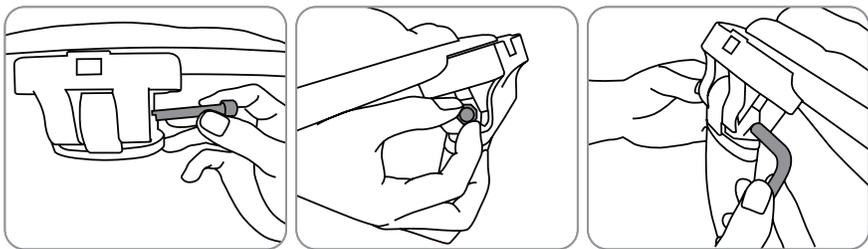
8. Зафиксируйте сиденье на раме в задней части блока управления болтом и гайкой.
