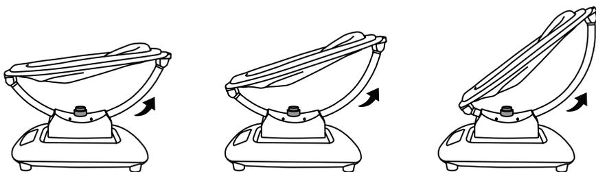
9. Ослабьте ручку фиксации, отрегулируйте угол наклона спинки (от 10° до 40°) и затяните ручку фиксации.
