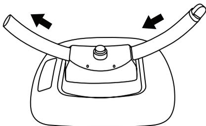
3. Проденьте основную раму через отверстия на блоке управления (от задней части по направлению к передней).
