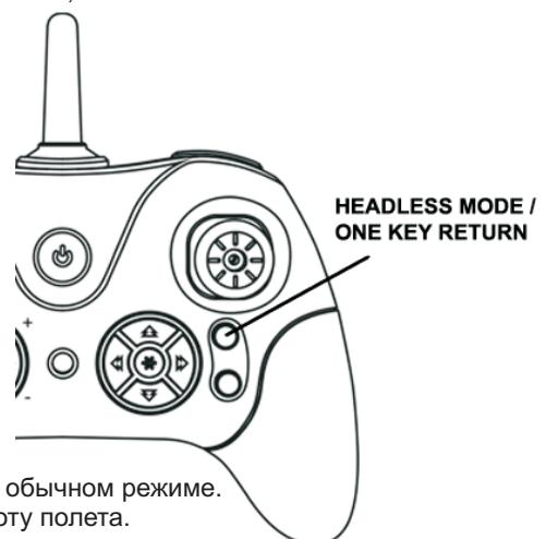
**РЕГУЛИРОВКА ВРАЩЕНИЯ** Если после взлета на 1,5 метра квадрокоптер непроизвольно вращается вокруг своей оси, такое вращение необходимо устранить при помощи **прерывистых** нажатий на триммер регулировки вращения (рис.):
