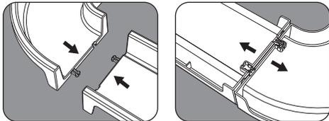
**Совет:** чтобы разъединить дорожки, держите их параллельно и осторожно потяните в стороны, чтобы избежать поломки.
