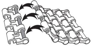
**ПРИМЕЧАНИЕ:** На сборку гусеницы для одного вездехода потребуется 20 модулей. В комплекте 2 экстра модуля.
