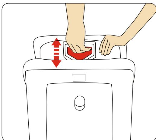
**Этап 2.** Нажмите рычаг регулировки подголовника и двигайте подголовник вверх и вниз, чтобы отрегулировать высоту ремней безопасности и подголовника в соответствии с ростом ребенка.
