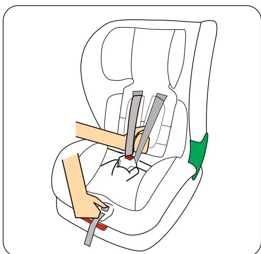
**Этап 1.** Ослабьте натяжение ремней безопасности. Одной рукой нажмите кнопку регулировки, чтобы разблокировать ремни, другой – тяните ремни безопасности в направлении наружной стороны.
