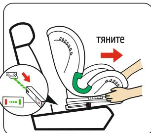
Нажмите на кнопку, чтобы разблокировать фиксатор системы ISOFIX и снять автокресло.
