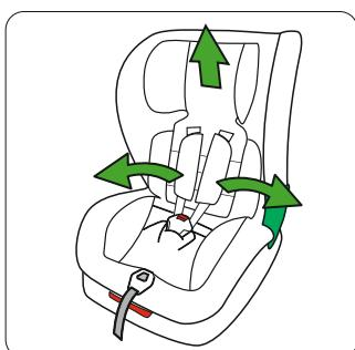
Установите подголовник в самое высокое положение, выньте вкладыш. Затем расстегните пряжку ремней безопасности и снимите накладки на плечевые ремни.
