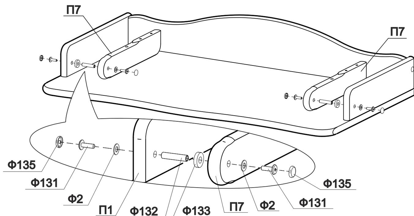
Если в процессе эксплуатации винты М6х20(Φ131) раскручиваются, нужно убрать одну или две шайбы(Φ2) и снова затянуть винты при помощи двух ключей шестигранных(Φ46)
