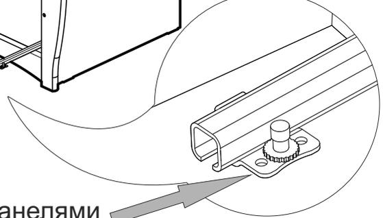
Диск для регулировки зазоров между панелями
