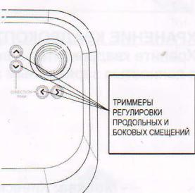
**РЕГУЛИРОВКА СМЕЩЕНИЙ** Если после взлета на 1,5 метра квадрокоптер непроизвольно смещается вбок в одну из сторон (вправо/влево), такое смещение необходимо устранить при помощи **прерывистых** нажатий на триммер регулировки боковых смещений со стрелкой, направленной в сторону, противоположную направлению непроизвольного смещения.
