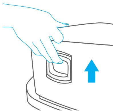
Вы можете проверить, совместимо ли это удерживающее устройство с системой ISOFIX вашего автомобиля. Фиксаторы ISOFIX можно задвинуть в корпус удерживающего устройства, что сделает возможной его установку с помощью креплений ISOFIX.
