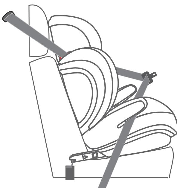
Удерживающее устройство должно быть зафиксировано 3-точечным ремнем безопасности, даже если в нем не находится ребенок.
