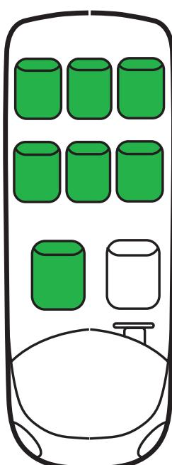
Одобренные для установки сиденья автомобиля, оснащенные 3-точечными ремнями безопасности, показаны зеленым. Рекомендуется устанавливать на заднем сиденье.
