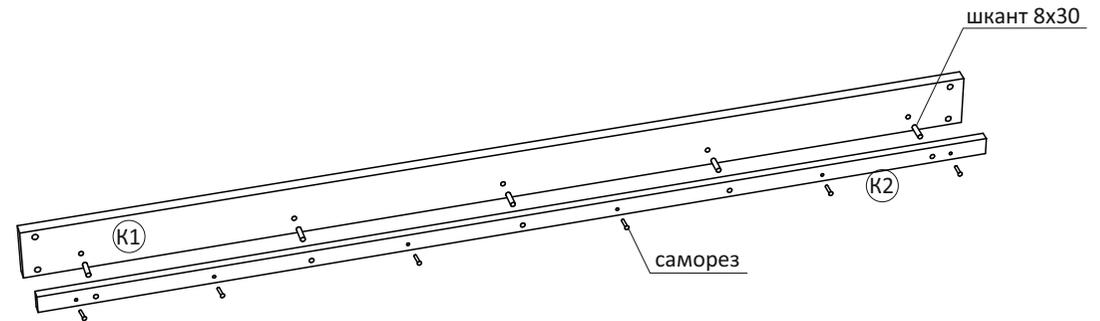
2.1 Собрать каркас кровати - соединить спинки кроватей п.1 с длинными царгами K1 на винты M6x90 и гайки-бочонки.
