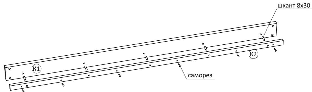
2.1 Собрать каркас кровати - соединить спинки кроватей п.1 с длинными царгами K1 на винты M6x90 и гайки-бочонки.
