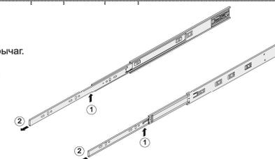
3. Закрепите саморезами внутренние подвижные планки направляющих к боковым стенкам ящика. Рекомендуется вкрутить один из саморезов в отверстие в форме звездочки
