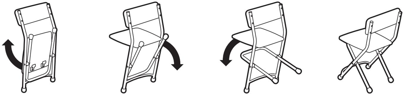
(рис. 3) Схема раскладывания стула с мягкой обивкой
