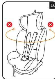
При повороте сиденья кнопка должна зафиксироваться до щелчка, когда будет достигнуто желаемое положение. Попробуйте покрутить автокресло, чтобы убедиться, что механизм заблокирован (рис. 16).
