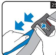
Возьмите якорный ремень и при необходимости удлините его, нажав на стопорную кнопку, чтобы высвободить ремень. Потяните его для регулировки (рис. 25).
