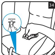
Проденьте металлическую пластину снизу и поставьте ее в вертикальное положение. Надавите вверх и пропустите через отверстие (рис. 34).
