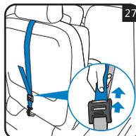
Для натяжения потяните за свободный конец якорного ремня. Якорный ремень считается надежно зафиксированным, когда индикатор натяжения будет полностью зеленым (рис. 27).
