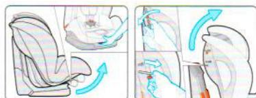
\* Надавите регулирующее устройство и вытяните лямку ремня безопасности из фиксатора с другой стороны, чтобы разблокировать его.
