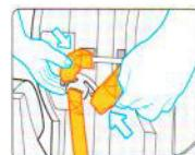
\* Застегните замок ремней безопасности и полностью закрепите обивку на корпусе автокресла. Проверьте работоспособность регулятора натяжения ремней безопасности.
