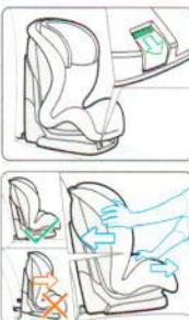
Проверьте надежность крепления, потянув корпус автокресла на себя, если автокресло качается и разъемы ISOFIX вырываются, пожалуйста, повторите описанную выше процедуру и установите его снова.
