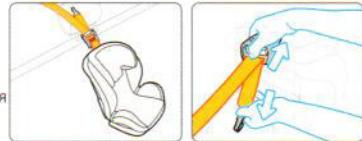
Закрепите карабин ремня за скобу. Проверьте, возможны 3 положения крепления, найдите положение, которое подходит для вашего автомобиля.
