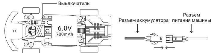
Откройте крышку батарейного отсека на машине. Установите аккумулятор в корпус машины. Проверьте, что выключатель питания на машине находится в положении OFF.
