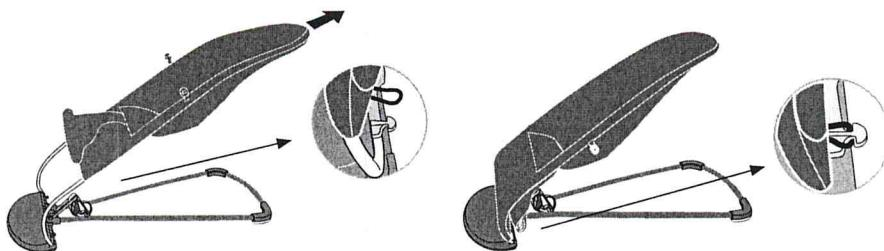
Если вы хотите использовать данное изделие в качестве обычного кресла, просто переверните тканевое сиденье. Ослабьте пуговицы системы фиксации. Затем ослабьте две эластичные петли в нижней части изделия и снимите тканевое сиденье с рамы.
