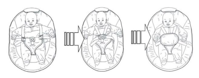
Ремень должен быть закреплен следующим образом, как показано на рисунках ниже.
