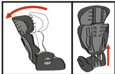
Перед снятием спинки внутренние 5-ти точечные ремни должны быть демонтированы (см. п. 2.1).
